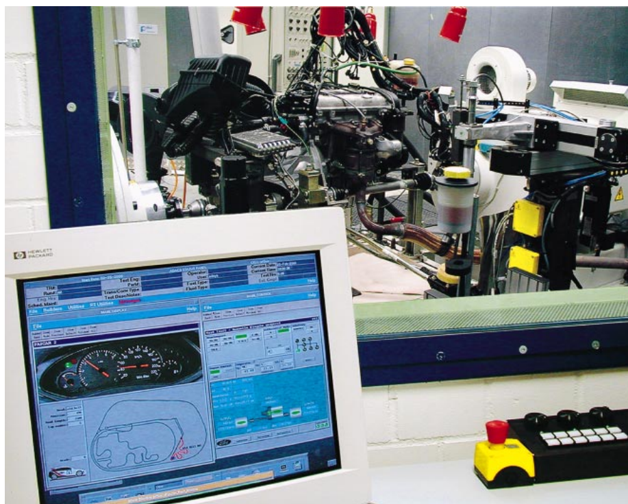
Bild 8: Fahrstreckensimulation, realisiert auf einem Powertrain-Prüfstand
