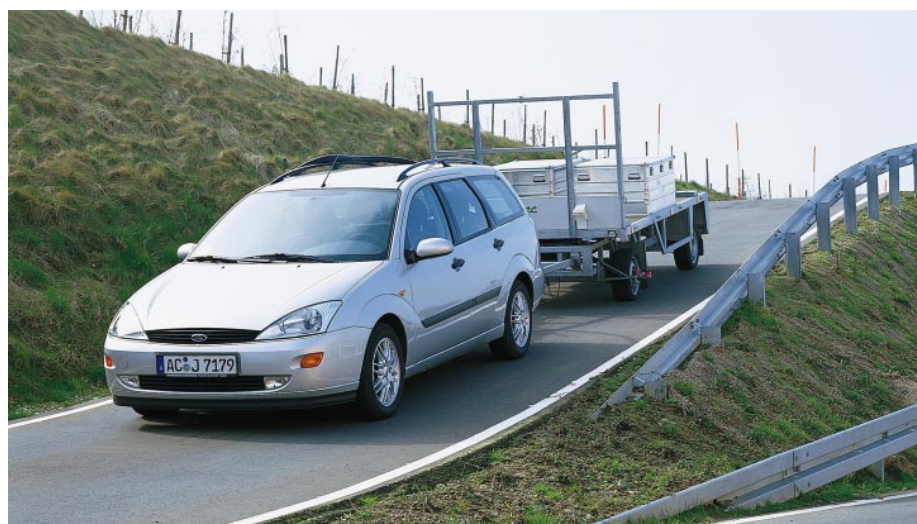
Bild 5: Messsystem mit Zugfahrzeug an einer Gefällestrücke (GIF-Testzentrum Alsdorf)
